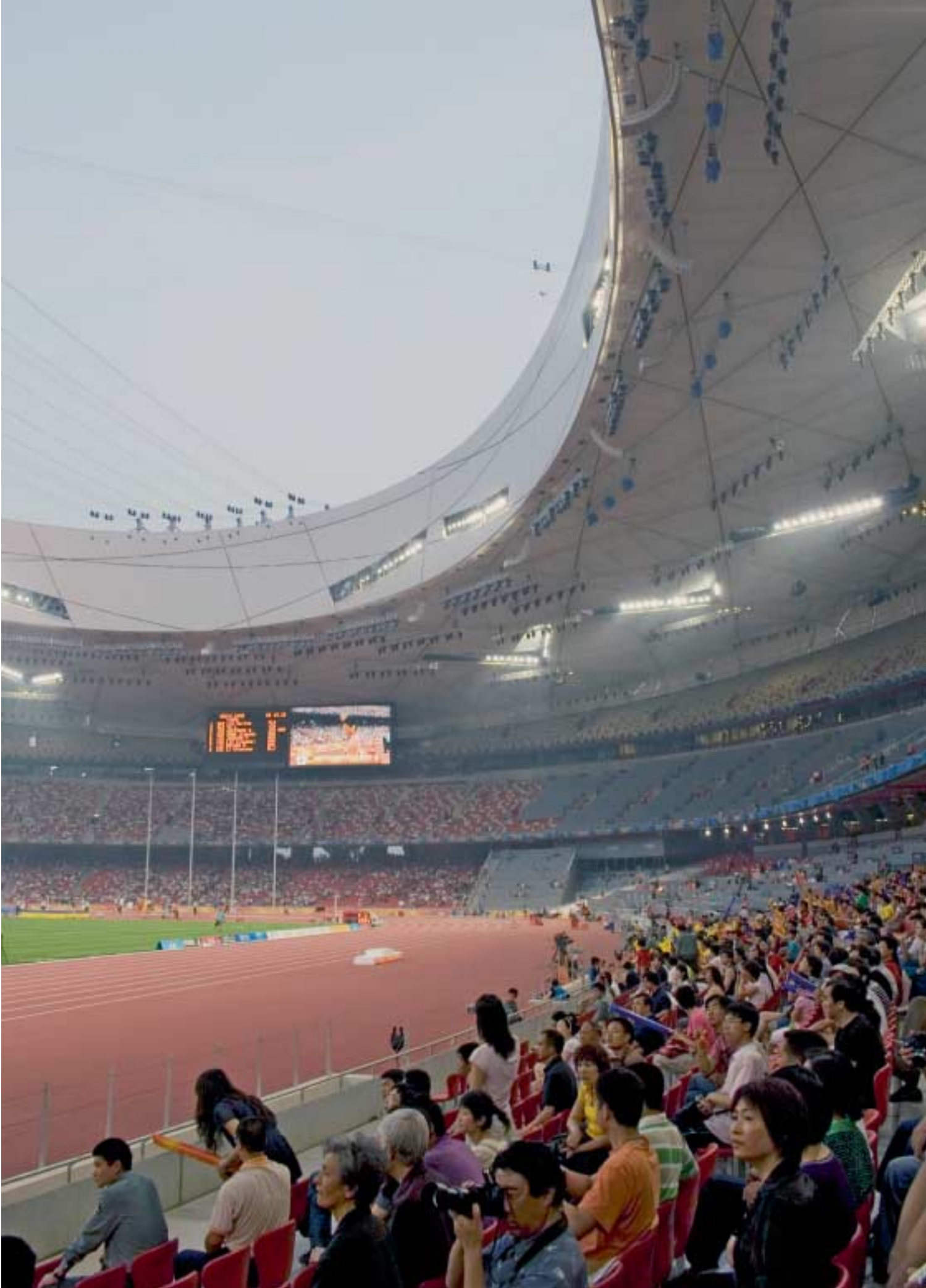
Abb. 9: Das weit auskragende Stadionsdach schützt die meisten Tribünenplätze
